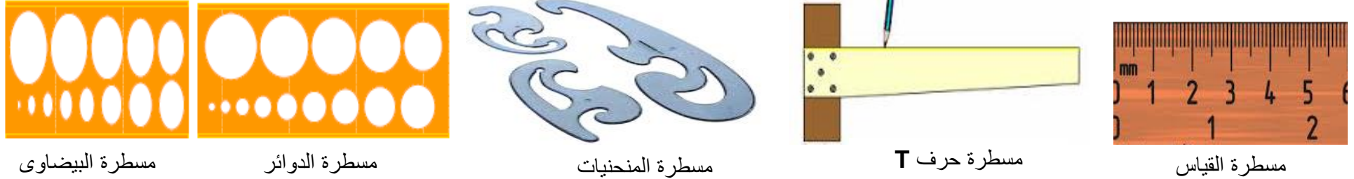
شكل (١ - ٤) أنواع مساطر القياس
